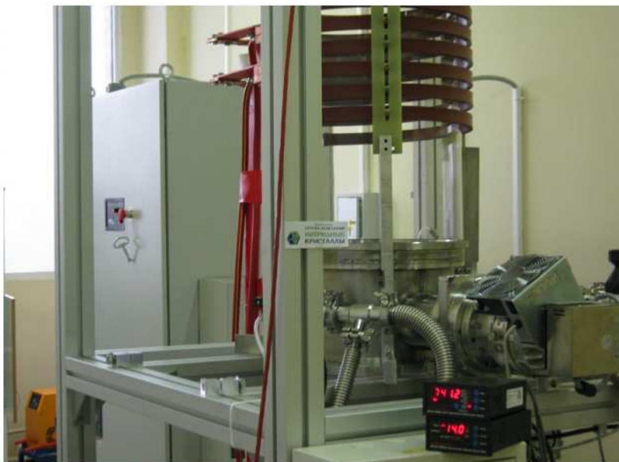
Рис. 1. Установка с индукционным нагревом для сублимационного роста SiC диаметром до 4”.
