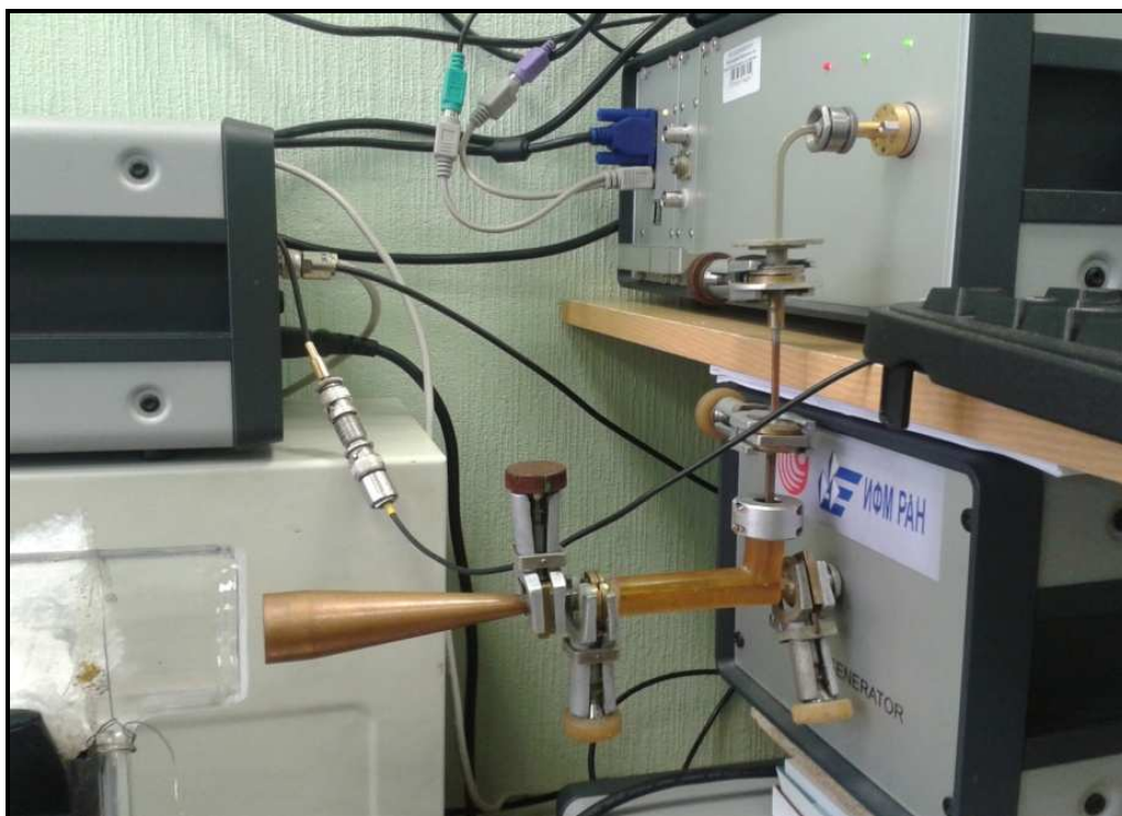
Рис. 2. Система ввода излучения двух источников в измерительный тракт.
