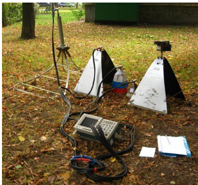
Рис.1 – Общий вид комплекса ЭМИ СШП зондирования с четырьмя типами приёмных антенн: м-: м 1 -: дм-: дм 1 - диапазонов (справа показана генераторная антенна м1- диапазона). Приёмник – цифровой осциллограф TDS3054
