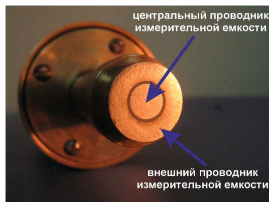
Рис.2. Внешний вид резонансной ближнепольной измерительной системы.
