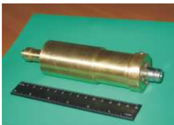
Рис.2. Внешний вид резонансной ближнепольной измерительной системы.
