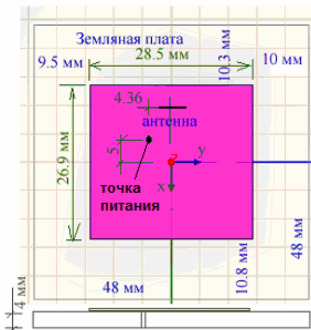
Рис. 6.32. Микрополосковая антенна с одним элементом питания
