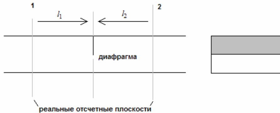
Рис. 2.9. К сдвигу отсчетных плоскостей
