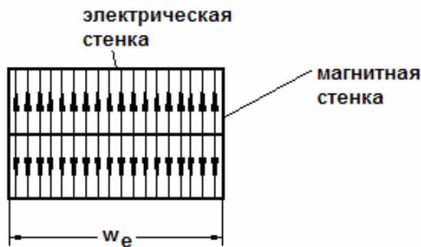
Рис. 8.8. Модель Олинера для полосковой линии
