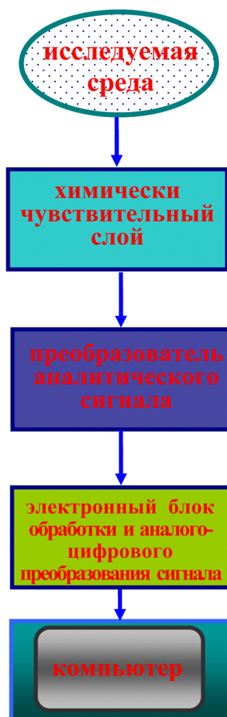
Рис. 1. Функциональная схема измерения с помощью химического сенсора.
