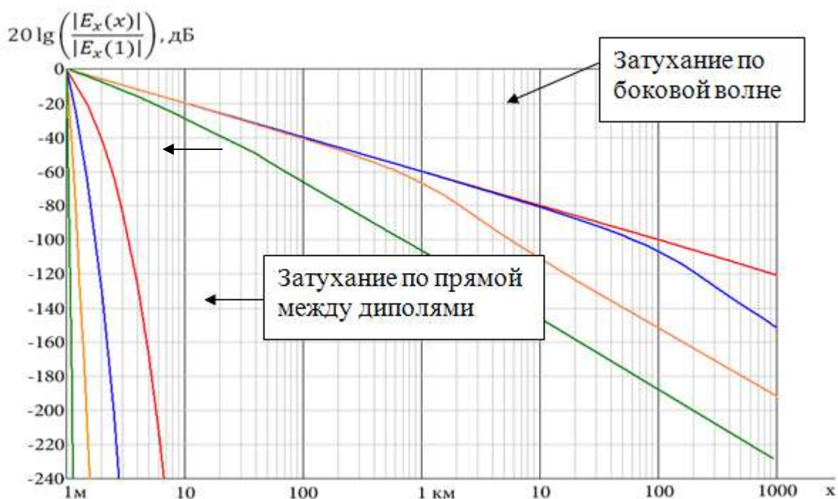
Рис. 4. Сравнение зависимостей уровня сигнала от расстояния между горизонтальными диполями в морской воде при передаче энергии боковой волной и по прямой на разных частотах. Параметры воды: \epsilon' = 75 , \sigma = 4 \frac{1}{\text{Ом}\cdot\text{м}} , глубина погружения диполей -x \approx 0 \text{ м} .
