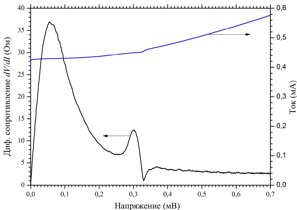
Рис.3. Вольтамперная характеристика и зависимость дифференциального сопротивления от напряжения джозефсоновского перехода, взаимодействующего с планарным открытым резонатором на подложке из сапфира  $D=114$  мкм при температуре  $T=5$  К.
