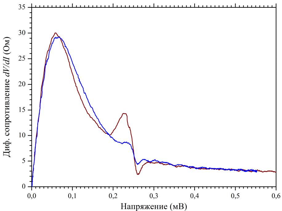
Рис.4. Зависимости дифференциального сопротивления от напряжения джозефсоновского перехода, взаимодействующего с планарным резонатором на подложке из сапфира  $D=144$  мкм, (1) – без тефлоновой подкладки, (2) – с тефлоновой подкладкой, толщиной ~20 мкм.
