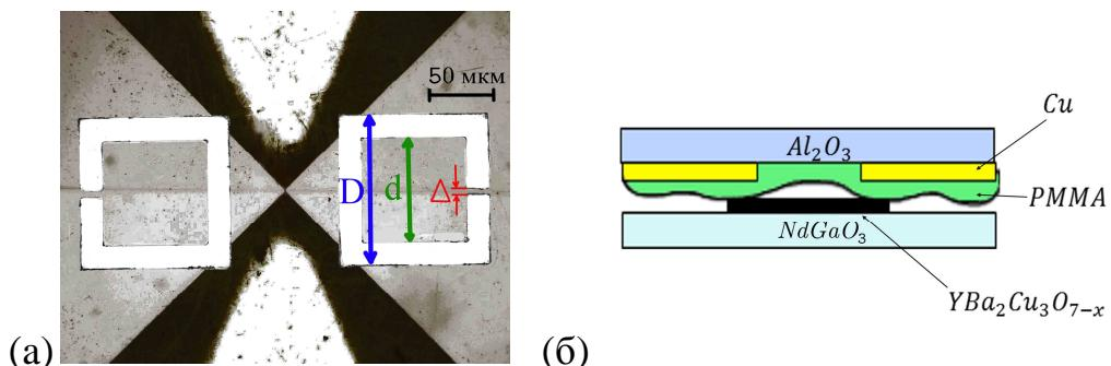
Рис.2. (а) – фото джозефсоновского перехода с приложенным планарным резонатором; (б) – схематическое представление слоев сборки джозефсоновского перехода и планарного резонатора.
