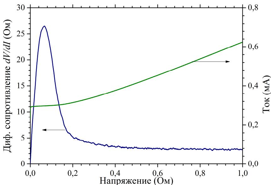
Рис.1. Вольтамперная характеристика  $I(V)$  и зависимость дифференциального сопротивления  $R_d(V)=dV/dI$  автономного бикристаллического джозефсоновского перехода из  $\text{YBa}_2\text{Cu}_3\text{O}_{7-x}$  при температуре  $T=5$  К в магнитном поле  $H=80$  Гс
