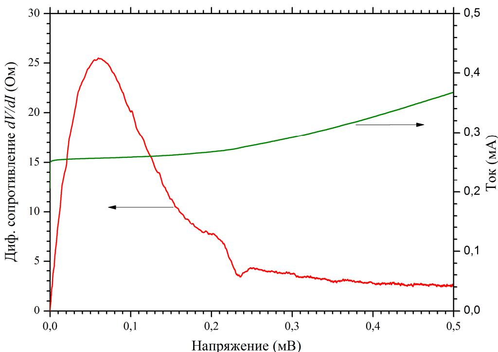
Рис.5. Вольтамперная характеристика и зависимость дифференциального сопротивления от напряжения джозефсоновского перехода, взаимодействующего с планарным открытым резонатором на подложке из
