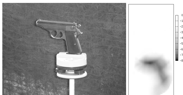
Рисунок 9. Открытый макет пистолета. Оптическое и радиоизображение.
