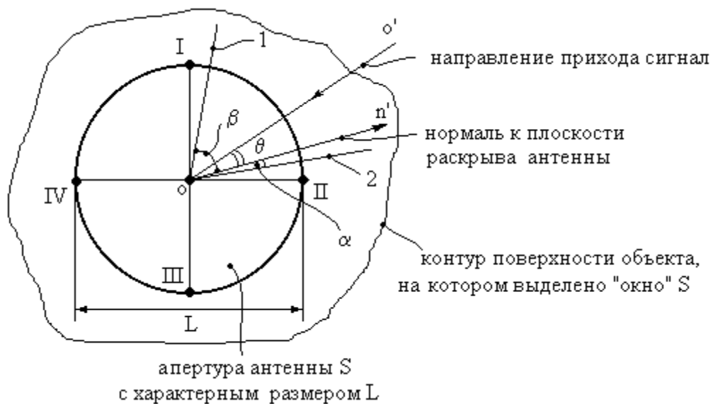
Рис. 1. Угловые соотношения направления прихода сигнала и плоскости апертуры антенны I, II, III, IV, где:
