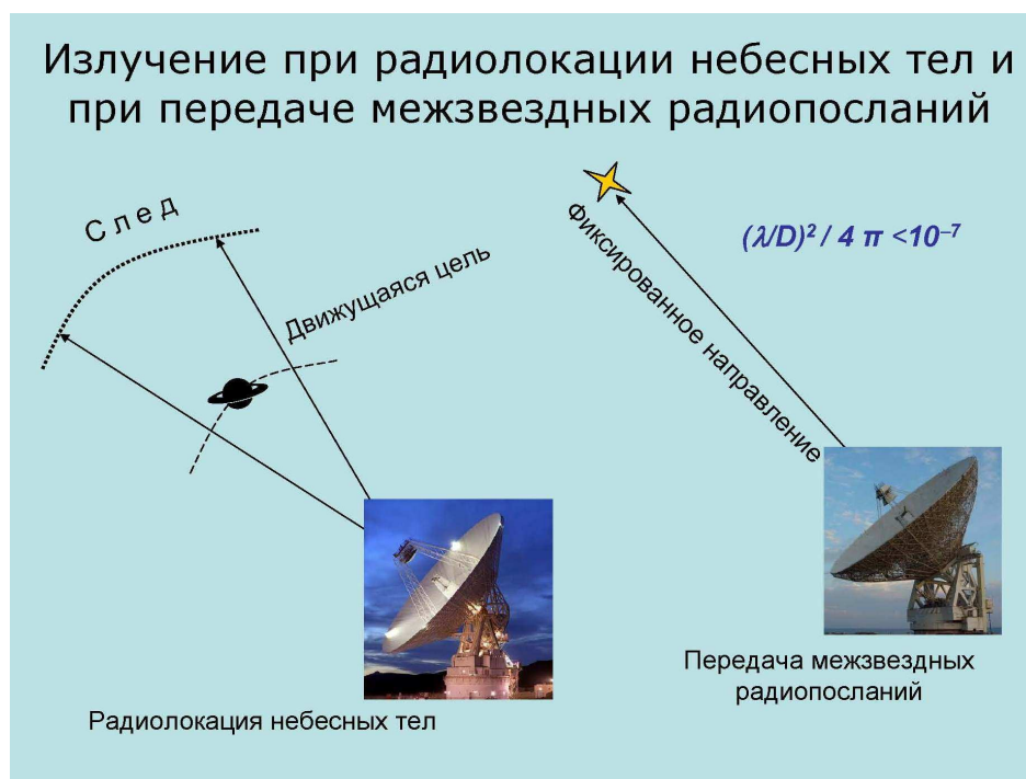
Рис. 2. Особенности излучения при радиолокации небесных тел и при передаче МРП.
