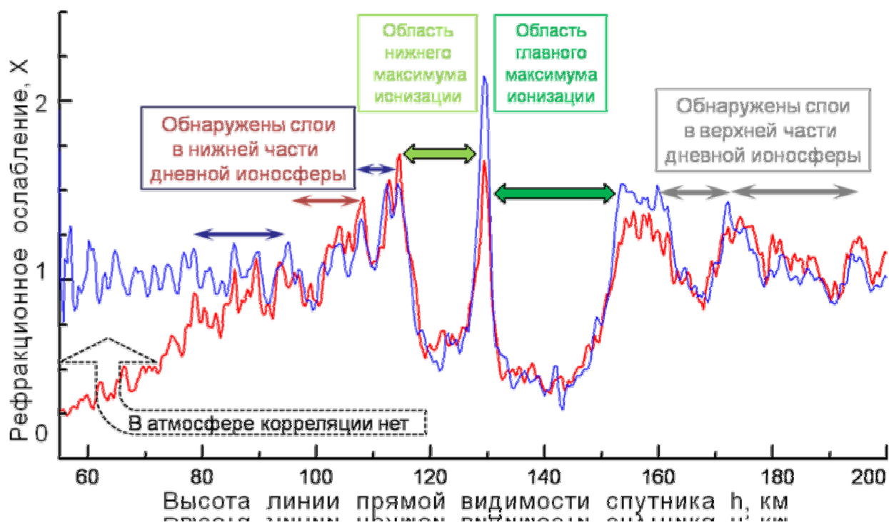
Рис.3. Сравнение рефракционных ослаблений ДМ-сигнала при радиопросвечивании ионосферы и атмосферы на дневной стороне Венеры, полученных по измерениям мощности X_{DM} (красная кривая) и вычисленных из частотных данных X_{\Delta f}(t) (синяя кривая).
