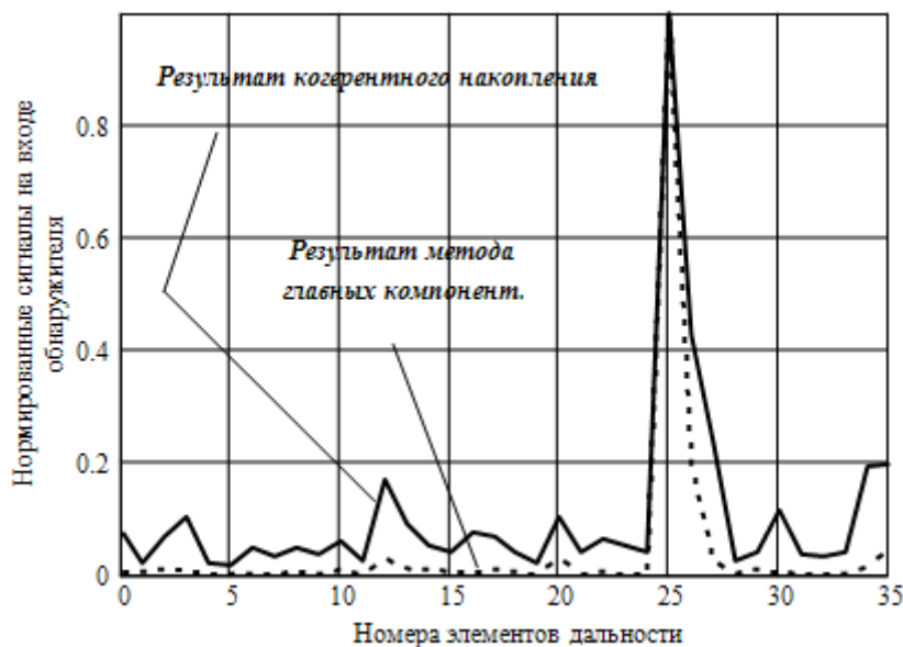
Рис. 1. Соотношение эффективности когерентного накопления отраженных РЛ сигналов и метода главных компонент для борта автомобиля
