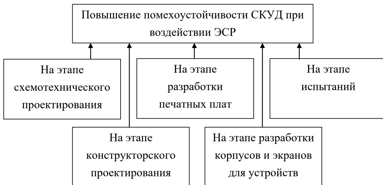
Рис. 5. Этапы повышения помехоустойчивости СКУД при воздействии ЭСР.
