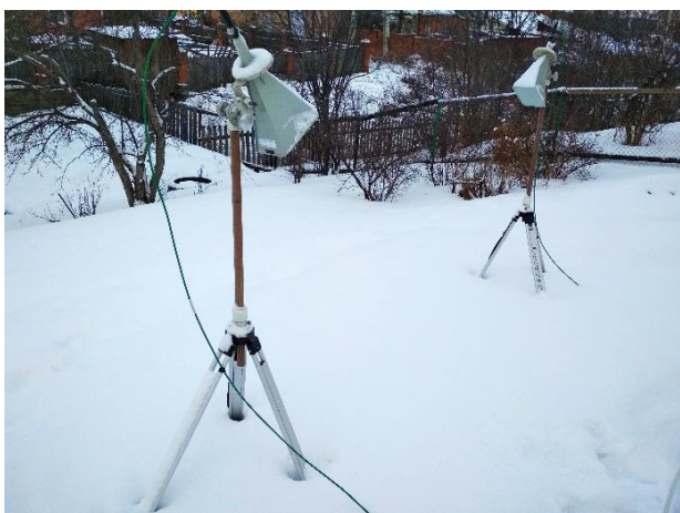
Рис. 1. Фотография тестового участка с установленным рефлектометром (06.03.2020).
