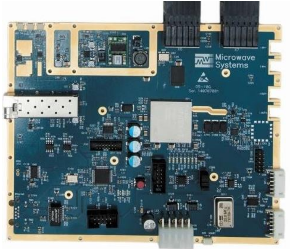
Рис.3 Изображение платы ЦОС (цифровой обработки сигналов) и управления с установленным на ней кристаллом ПЛИС (программируемой логической интегральной микросхемы) Xilinx Kintex 7 XC7K410T
