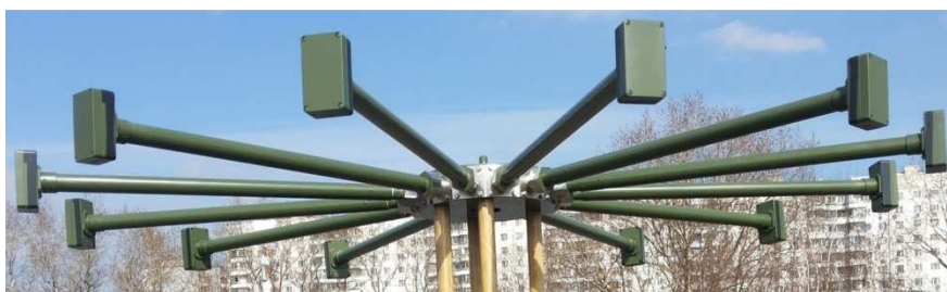
Рис. 5. Активная 13-элементная кольцевая антенная решетка.
