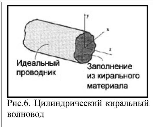
Рис.6. Цилиндрический киральный волновод
