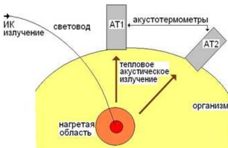
Рис. 1. Схема акустотермометрии при глубинной лазерной гипертермии.
