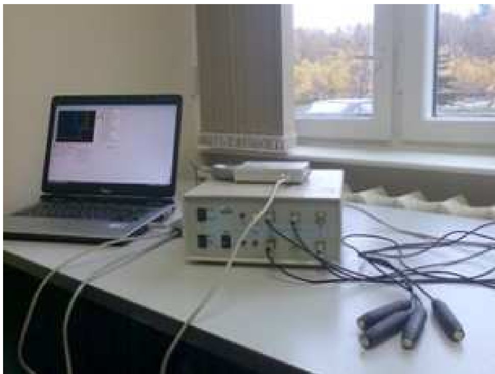
Рис. 2. Многоканальный акустотермограф, разработанный в ИПФ РАН.
