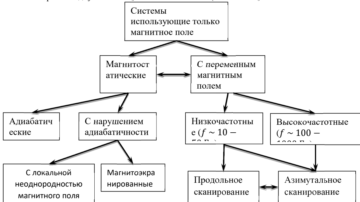
Рис.1. Классификация коллекторных систем гиротронов с магнитным полем.
