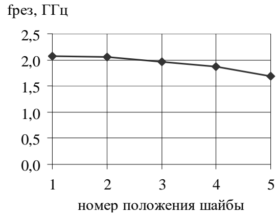
Рис. 4. Зависимость коэффициента усиления антенны от положения шайбового элемента на штыре.
