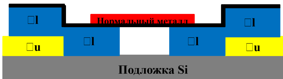
Рис. 2. Схематическое изображение СИНИС структуры в разрезе .
