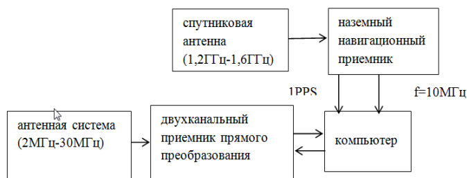
Рис. 2 Структурная схема АПМ с внешним опорным напряжением f = 10 МГц, секундным импульсом PPS, формируемым от синхронизирующего спутникового приемника
