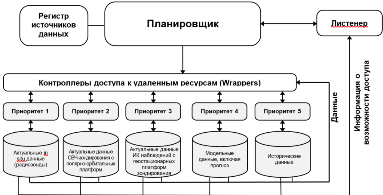
Рис. 1. Функциональная схема системы обнаружения и мониторинга МКК.
