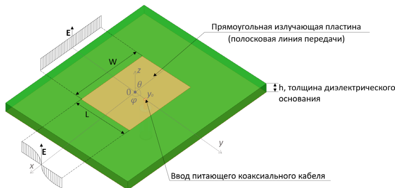
Рисунок 1 – Внешний вид печатной прямоугольной антенны (вид сверху) и распределение электрической составляющей поля в резонаторе излучателя
