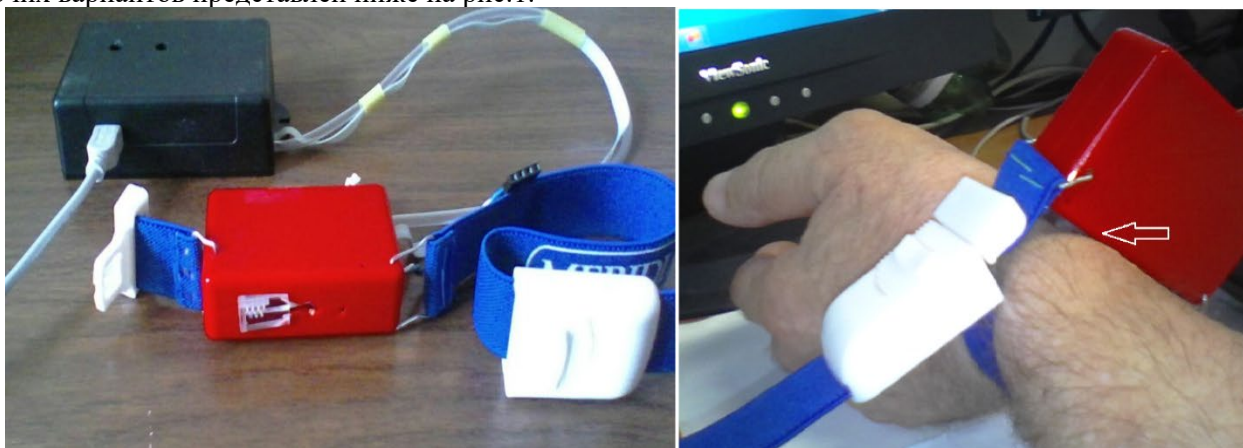
Рис. 1. Датчик артериального давления и его рабочее положение на лучевой артерии
