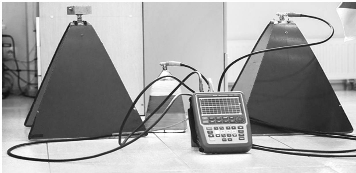
Рис. 2. Общий вид комплекса ЭМИ СШП зондирования: передающая микрополосковая антенна с ДДРВ - генератором (слева), далее - приёмные антенны дециметрового (дм-) и метрового (м-) диапазонов длин волн, приёмник – цифровой осциллограф R&S RTH1004
