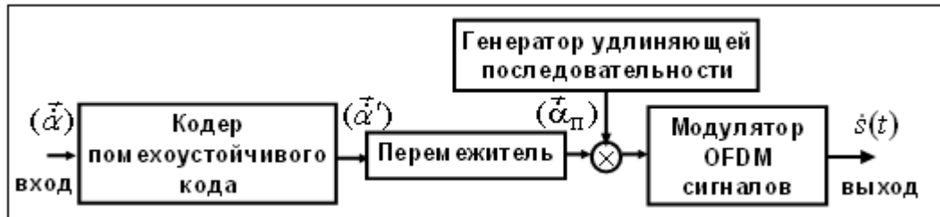
Рис.2. Схема формирования сигнальных конструкций на основе OFDM-сигналов, помехоустойчивого кодирования и перемежения.
