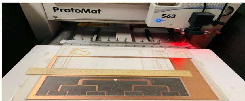
Рис. 5. Делитель мощности на полосковой линии.
