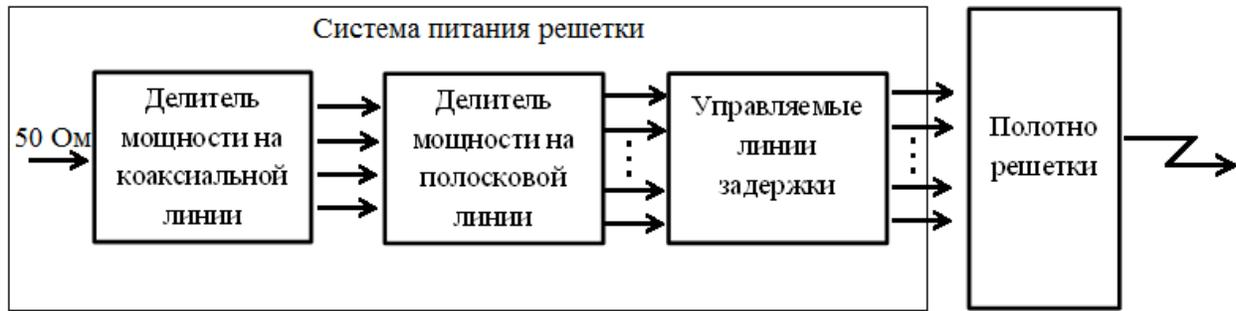
Рис. 1. Функциональная схема антенной решетки с системой питания.
