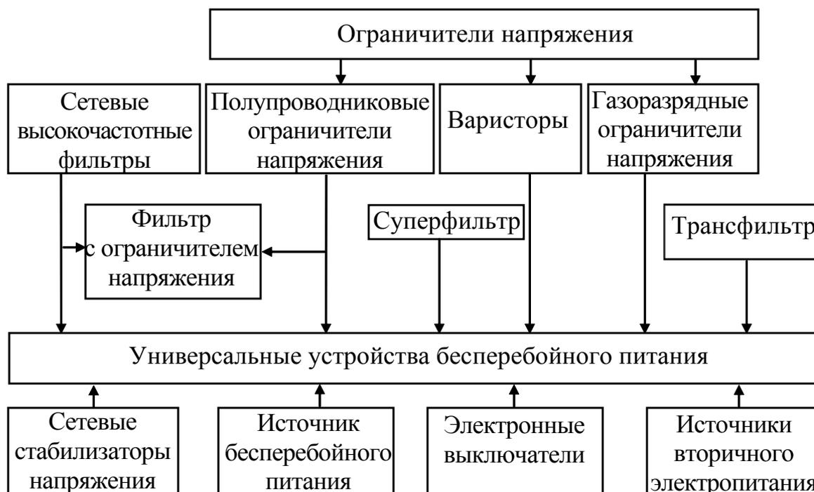
Рис. 8. Технические устройства повышения помехоустойчивости ВТ при воздействии электромагнитных помех по сети электропитания
