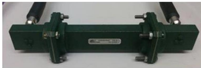
Рис. 1 – а) экспериментальная схема для измерения коэффициента прохождения: 1 – анализатор ZVA 24, 2, 5- КВП, 3 – волновод, 4 – образец; б) общий вид волновода, состыкованного с КВП.
