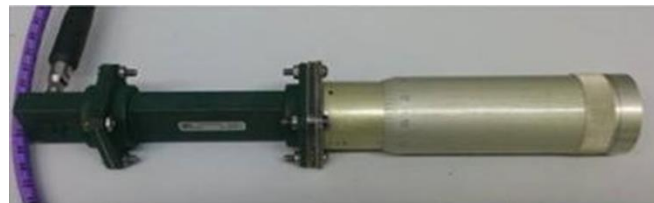
Рис.2 – а) экспериментальная схема измерения коэффициента отражения: 1 – анализатор ZVA 24, 2- КВП, 3 – волновод с образцом 4, 5– согласованная нагрузка (вариант I), либо поршень (вариант II); б) общий вид волновода с установленным образцом и присоединенными КВП и отражающим поршнем (измерения по схеме варианта II).
