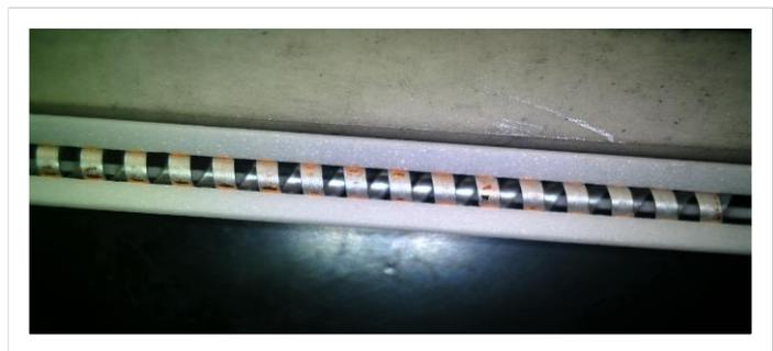
Рис. 1. а) Замедляющая система со спиралью без медного покрытия
