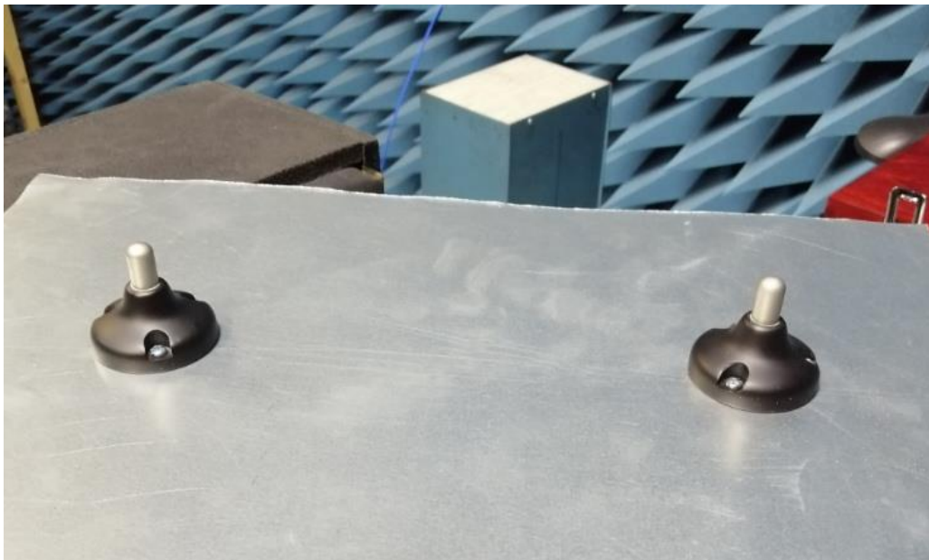
Рис. 6. Антенны на листе металла в процессе измерений.
