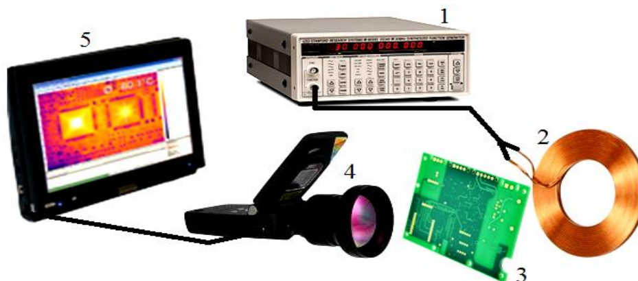
Рис.3. Экспериментальная установка ТВЭТ: 1 – ВЧ-генератор, 2 – плоский индуктор, 3 – исследуемый образец МПП, 4 – тепловизор, 5 – планшет.
