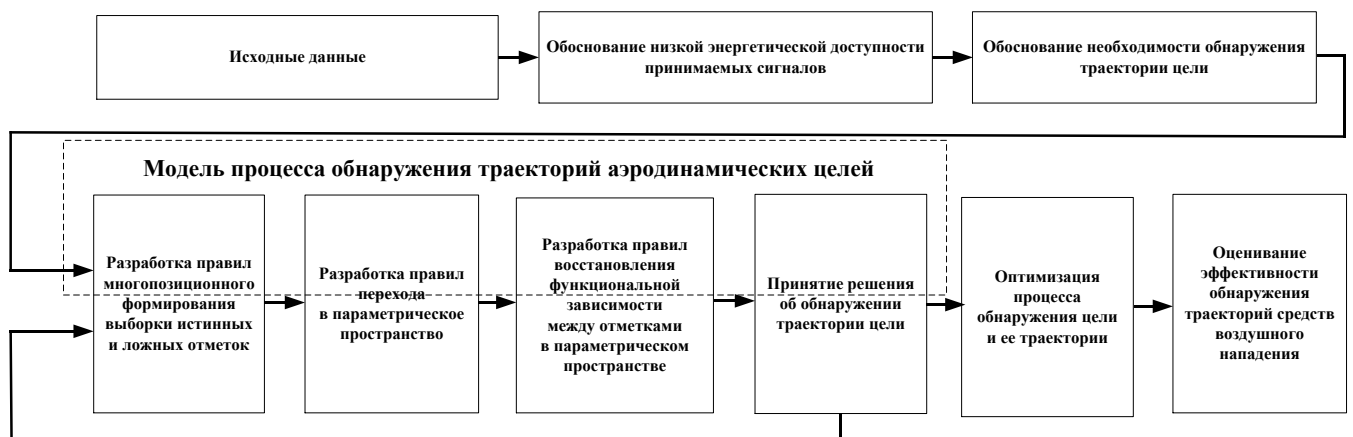
Рис. 1. Структурная схема разработки способа обнаружения аэродинамических целей в наземно-космической многопозиционной радиолокационной системе на основе параметрического анализа выборки отметок.
