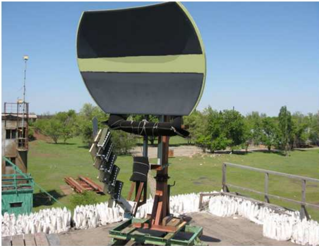
Рис. 9. Фото макета сверхширокополосной многолучевой зеркальной антенны
