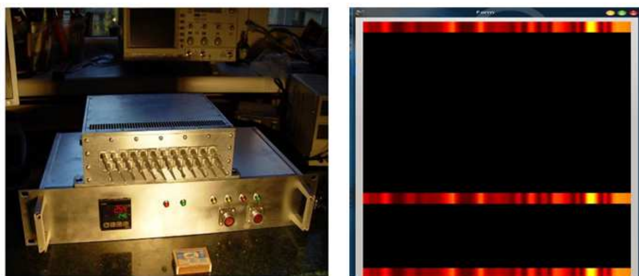
Рис. 3. Матричная приемная система с блоком питания и термостатирования (слева), пример визуализации трех каналов матрицы (№1, №16, №24) (справа)
