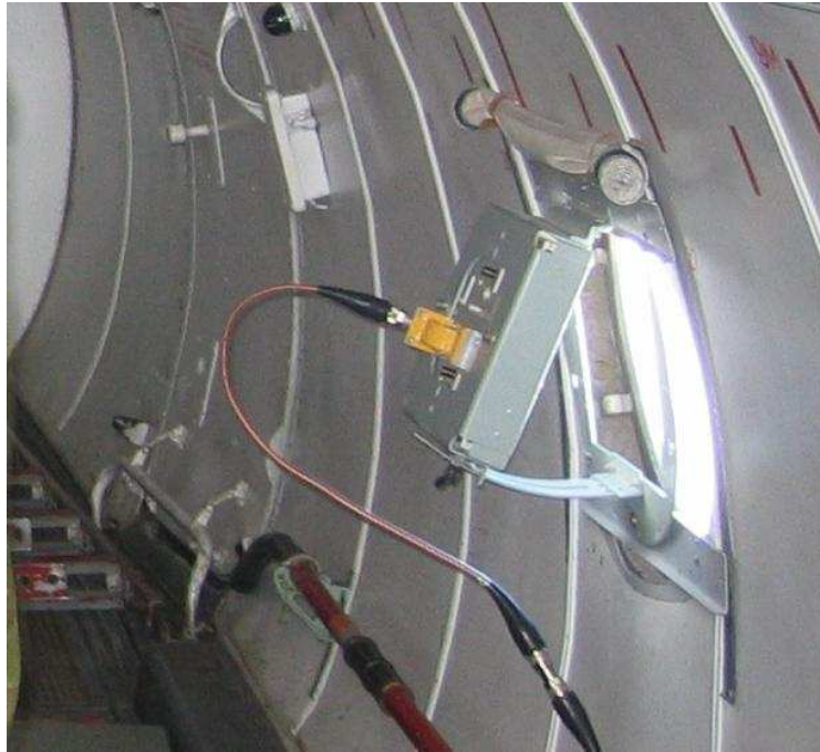
Рис.2. Антенна X диапазона в салоне самолета Ан-30.
