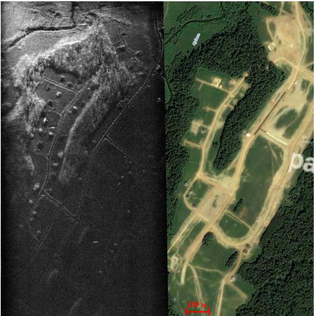
Рис. 14 – Синтезированное с борта самолета радиолокационное изображение земной поверхности в сравнении со спутниковой фотографией.
