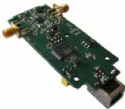
Рис. 1. Базовый приемо-передающий модуль Пикор-1.
