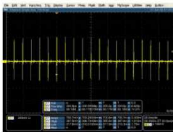
Рис. 4. Измерение максимальной частоты повторения импульсов
