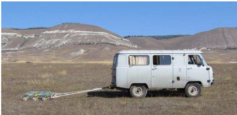
Рис.3. Процесс георадарного исследования археологического памятника - могильника "Левоподкумский" в Малокарачаевском районе КЧР.
