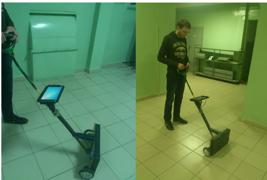
Рис.4. Лабораторный образец одноканального высокочастотного георадара.
