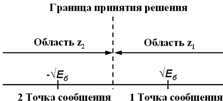
Рис. 2. Диаграмма пространства сигналов для когерентной системы с двоичной фазовой модуляцией
