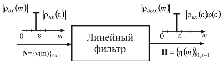
Рис. 3. Сохранение монохроматической структуры спектра входного КЗС при его линейной фильтрации.
