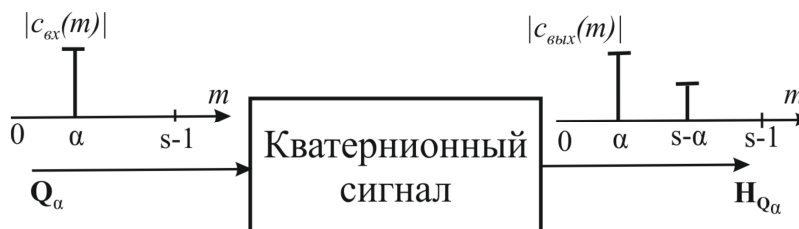
Рис. 4. Расщепление спектральной линии входного сигнала при прохождении через КФ.
