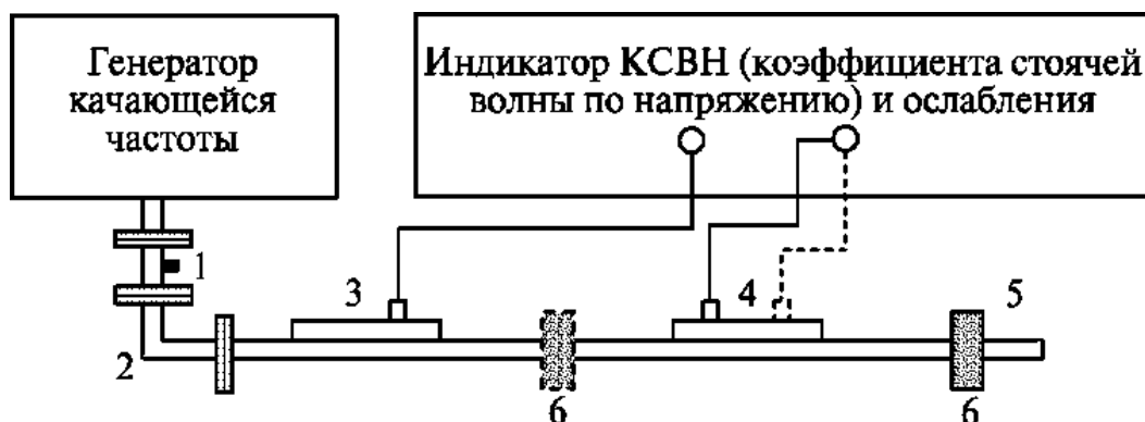
Рис. 1. Схема панорамного измерителя коэффициента стоячей волны и ослабления: 1 — аттенюатор; 2 — волноводный переход; 3 — направленный ответвитель падающей волны; 4 — направленный ответвитель отраженной волны; 5 — согласованная нагрузка; 6 — образец. Пунктир — расположение элементов при измерении ослабления.
